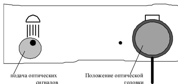
Рис. 10-7. Расположение элементов на счетчике
